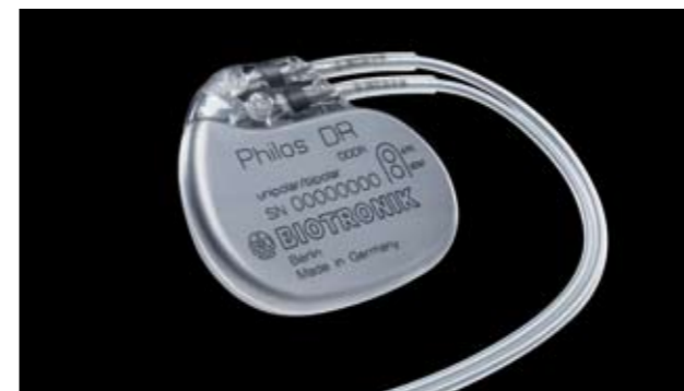
Szívpacemaker: titánburkolat vonalhegeztése és jelölése, belső elektronika ponthegeztése
